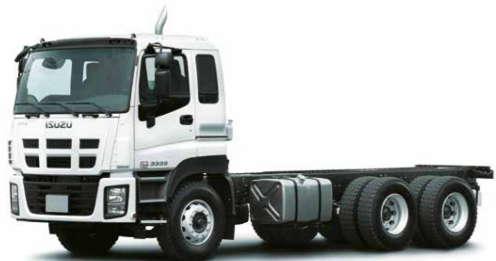
Вертикальная выхлопная труба с глушителем: только для модификаций CYZ52M и CYZ52P
