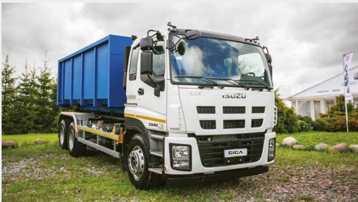
Автомобиль специальный с крюковым погрузчиком на шасси ISUZU GIGA 6×4
