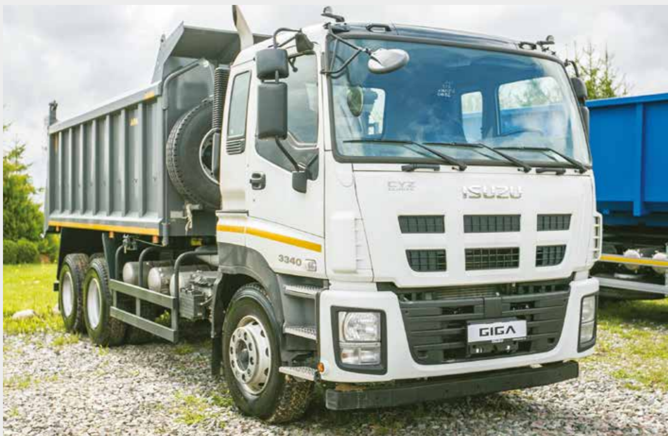
Автомобиль-самосвал 16м³ с задней разгрузкой на шасси ISUZU GIGA 6×4 (CYZ52M)
